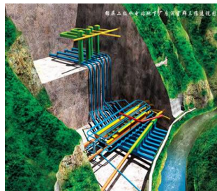
水电隧洞、地下厂房 (500-3000m)
