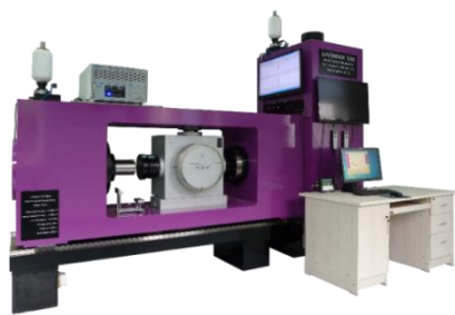
高压真三轴硬岩 实验装置
