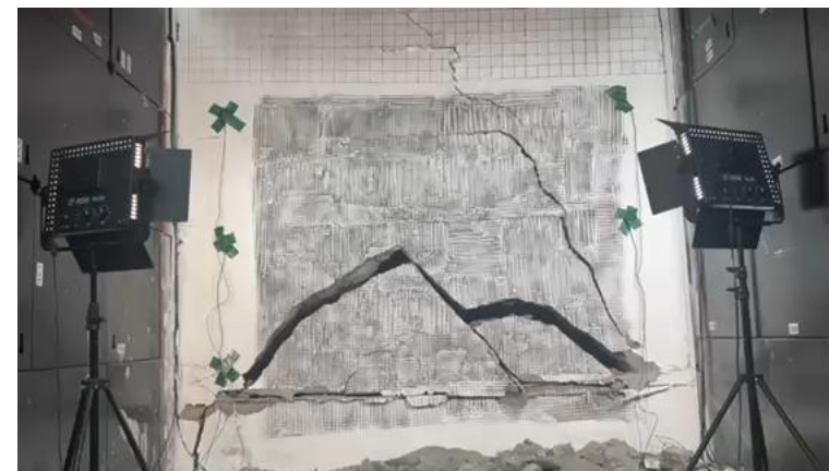
采煤沉陷物理模型试验最终破坏过程
