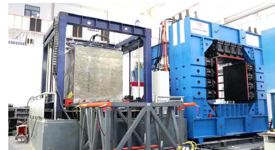
采矿过程三维物理 模型实验装置
