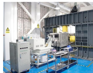
微波致裂效果综合 实验装置
