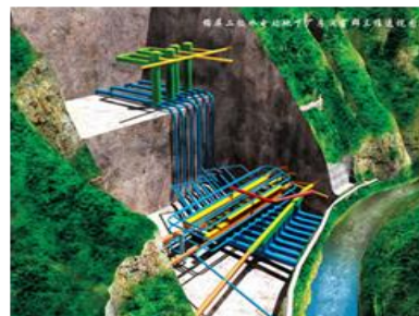
水电隧洞、地下厂房 (500-3000m)
