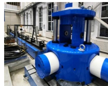
高压硬岩扰动真三轴 实验装置
