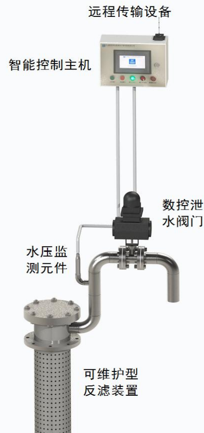
智能排水卸压系统结构与现场模型示意图
